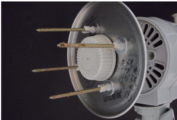
▲ 圖7 利用電風扇馬達製作第一代的「旋轉器」。
