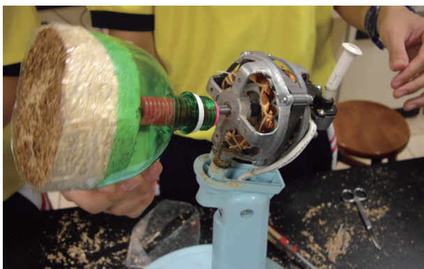
▲ 圖9 太空包在第二代的「旋轉器」運轉時，仍然因為轉速太快，太空包又飛出旋轉盤。
